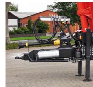
In hoogte verstelbare trekrichting met rubberlager
